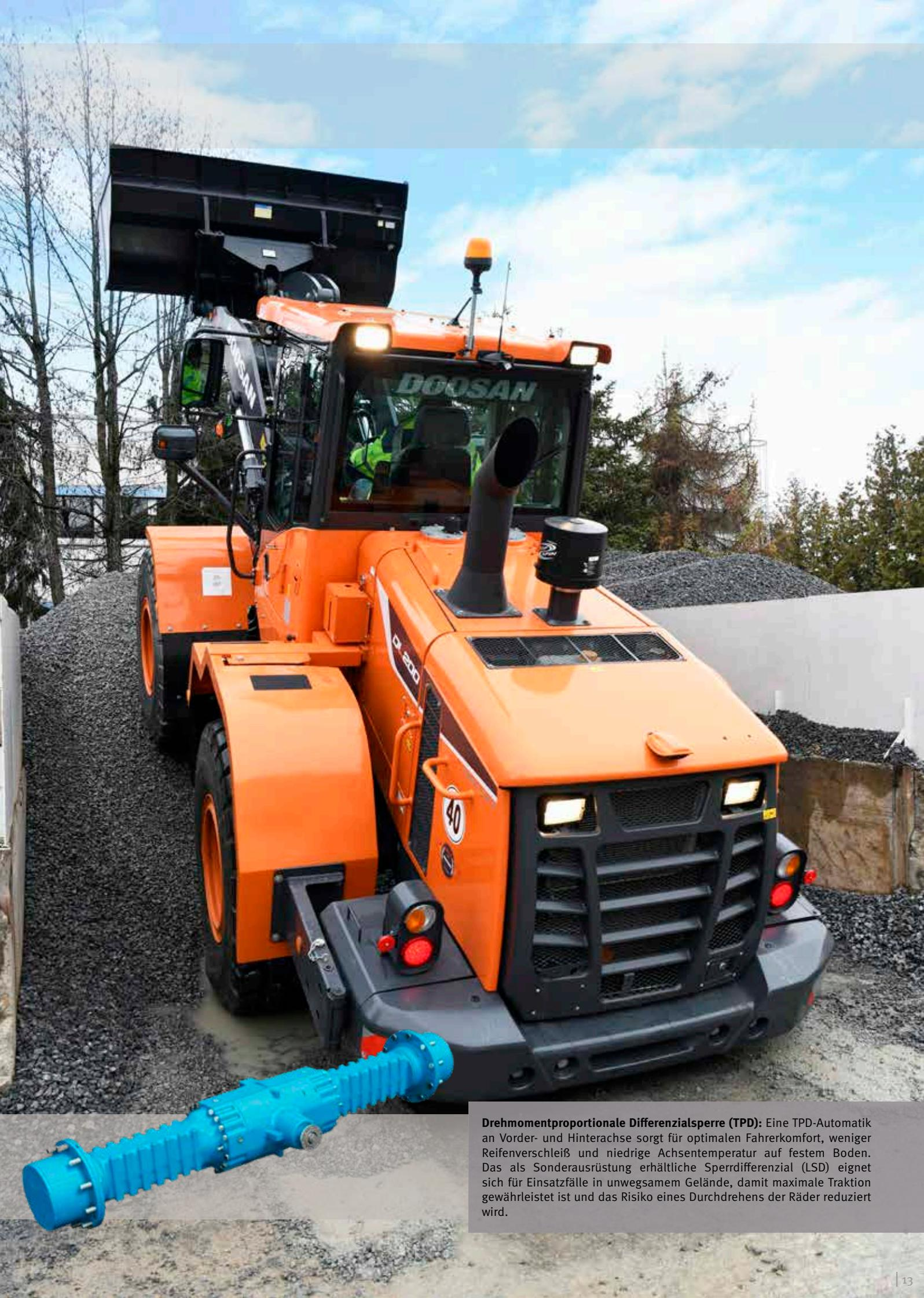
**Drehmomentproportionale Differenzialsperre (TPD):** Eine TPD-Automatik an Vorder- und Hinterachse sorgt für optimalen Fahrerkomfort, weniger Reifenverschleiß und niedrige Achsentemperatur auf festem Boden. Das als Sonderausrüstung erhältliche Sperrdifferenzial (LSD) eignet sich für Einsatzfälle in unwegsamem Gelände, damit maximale Traktion gewährleistet ist und das Risiko eines Durchdrehens der Räder reduziert wird.
