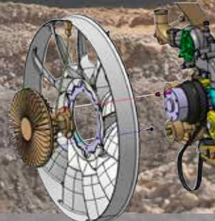
**Elektronische Visco-Lüfterkupplung:** Zur optimalen Kühlung wird die Lüfterdrehzahl über eine Lüfterkupplung elektronisch gesteuert, wodurch der Geräuschpegel des Lüfters und der Kraftstoffverbrauch sinken.
