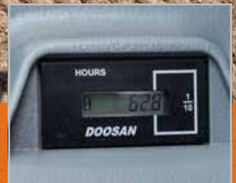
Betriebsstundenzähler (vom Boden aus ablesbar)
