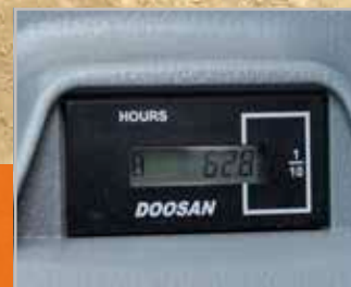
Betriebsstundenzähler (vom Boden aus ablesbar)
