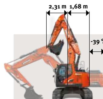
**Geringerer Heckschwenkradius:** Um den Einsatz in Innenstädten und auf engen Baustellen zu erleichtern, wurde der Heckschwenkradius im Vergleich zum herkömmlichen DX235LC-5 um 39 % verringert. Der geringste Schwenkdurchmesser beträgt nur 3,99 m.
