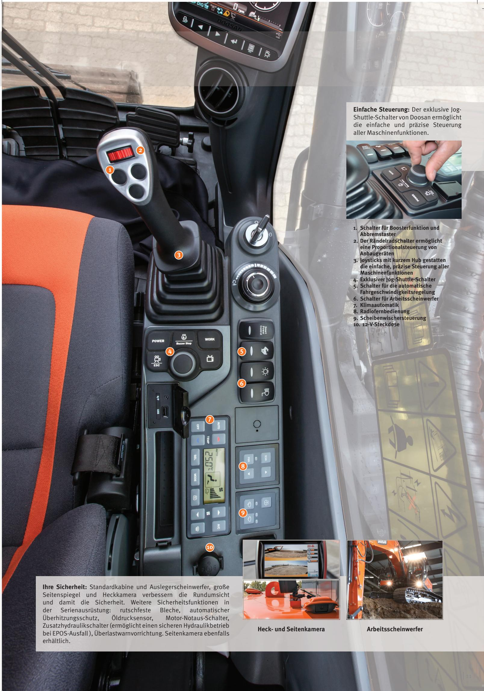
**Einfache Steuerung:** Der exklusive Jog-Shuttle-Schalter von Doosan ermöglicht die einfache und präzise Steuerung aller Maschinenfunktionen.
