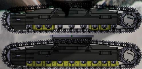
**Kettenschützer:** dienen der Sicherheit, Kettenausrichtung und besserer Fahrleistung der Maschine. 2 Kettenschützer pro Kette gehören zur Serienausrüstung (doppelte Kettenschützer und Kettenschützer über die volle Länge sind als Sonderausrüstung erhältlich). Diese verschiedenen Kettenoptionen bieten Ihnen die optimale Lösung auch für extreme Anwendungen.
