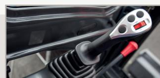
Proportional-Joystick mit Rändelradsteuerung
