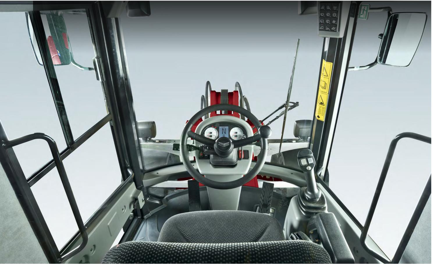
Die für Bedienerkomfort und Produktivität konzipierten Kabinen verfügen über Geräusch- und Vibrationsdämpfung sowie ROPS- und optionaler FOPS-Zulassungen.
