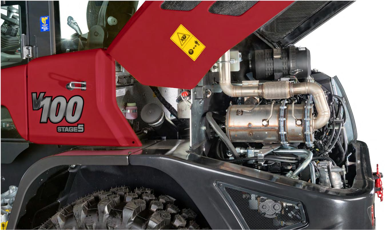
Für eine schnelle und einfache Wartung des Gerätes ermöglicht die große Öffnung der Motorhaube einen einfachen Zugang zu allen wichtigen Wartungselementen. Dies wird durch verbesserte Verbrennungs- und Einspritzsysteme, einen Dieseloxydationskatalysator (DOC) und einen Dieselpartikelfilter (DPF) erreicht.
