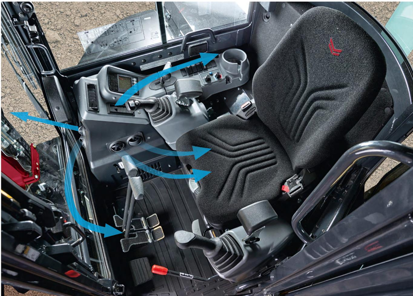
Bei der Entwicklung des Vi057-6B wurde Yanmars „Universal Design“-Konzept angewandt, um den Komfort und die Produktivität des Bedieners in den Mittelpunkt zu rücken – von der ergonomischen Platzierung des Türgriffs, der Handläufe, des Türschlusses und des Haubengriffs bis hin zum vergrößerten Fußraum.
