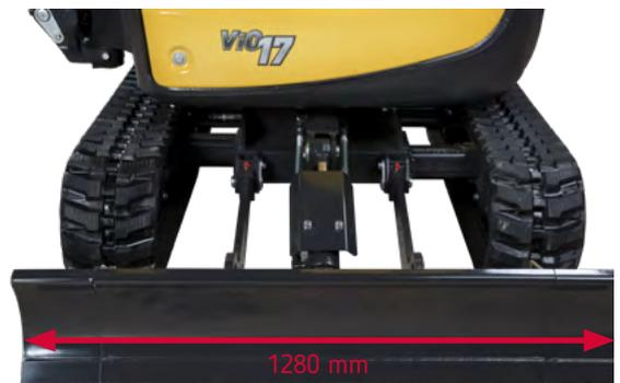
Ausgefahren: mehr stabilität für verbesserte greif- und ladeleistung
