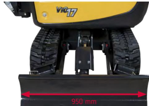
Eingefahren: einfacher zugang zu beengten bereichen
